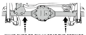
MAKE SURE TO FULLY SEAT THE SPRINGS INTO THE UPPER SPRING ISOLATOR
